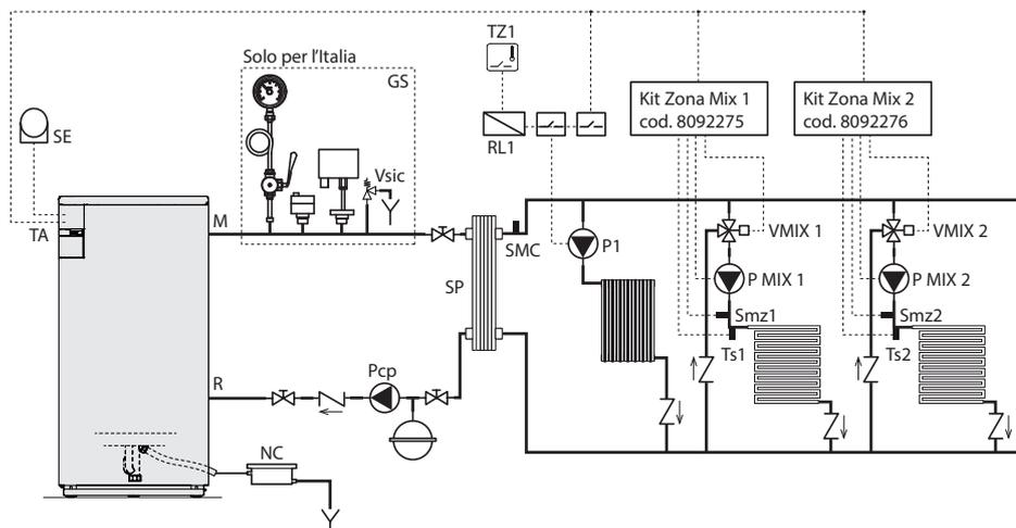
NOTA: Nel caso di impianti con CALDAIA SINGOLA possono essere gestiti fino a due impianti MIX o due gruppi di impianti MIX, installando gli accessori opzionali KIT ZONA MIX 1 (cod. 8092275) e KIT ZONA MIX 2 (cod. 8092276).
