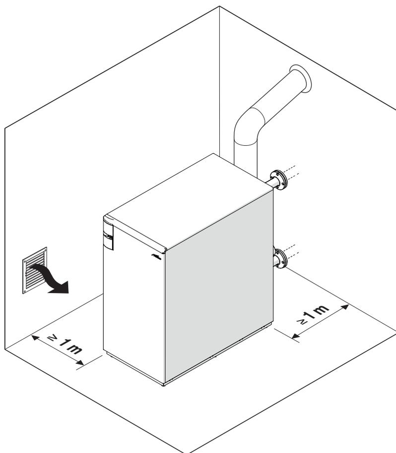
Il locale di installazione deve sempre essere rispondente alle Norme Tecniche ed alla Legislazione vigente. Deve essere dotato di aperture di aerazione adeguatamente dimensionate per le installazioni di TIPO B.
