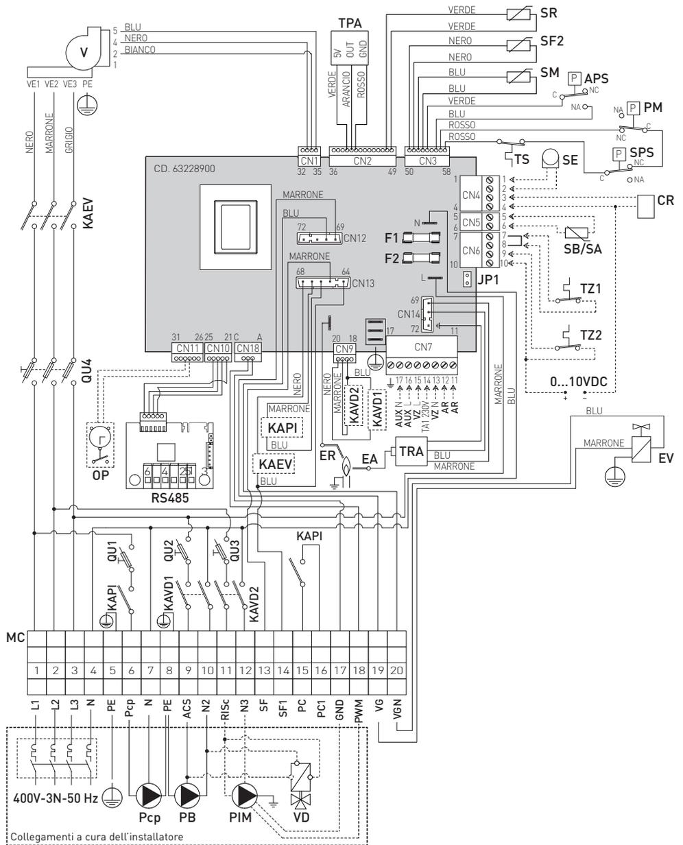
(\*) La pompa PIM (modulante) può essere installata in alternativa alla pompa Pcp.
